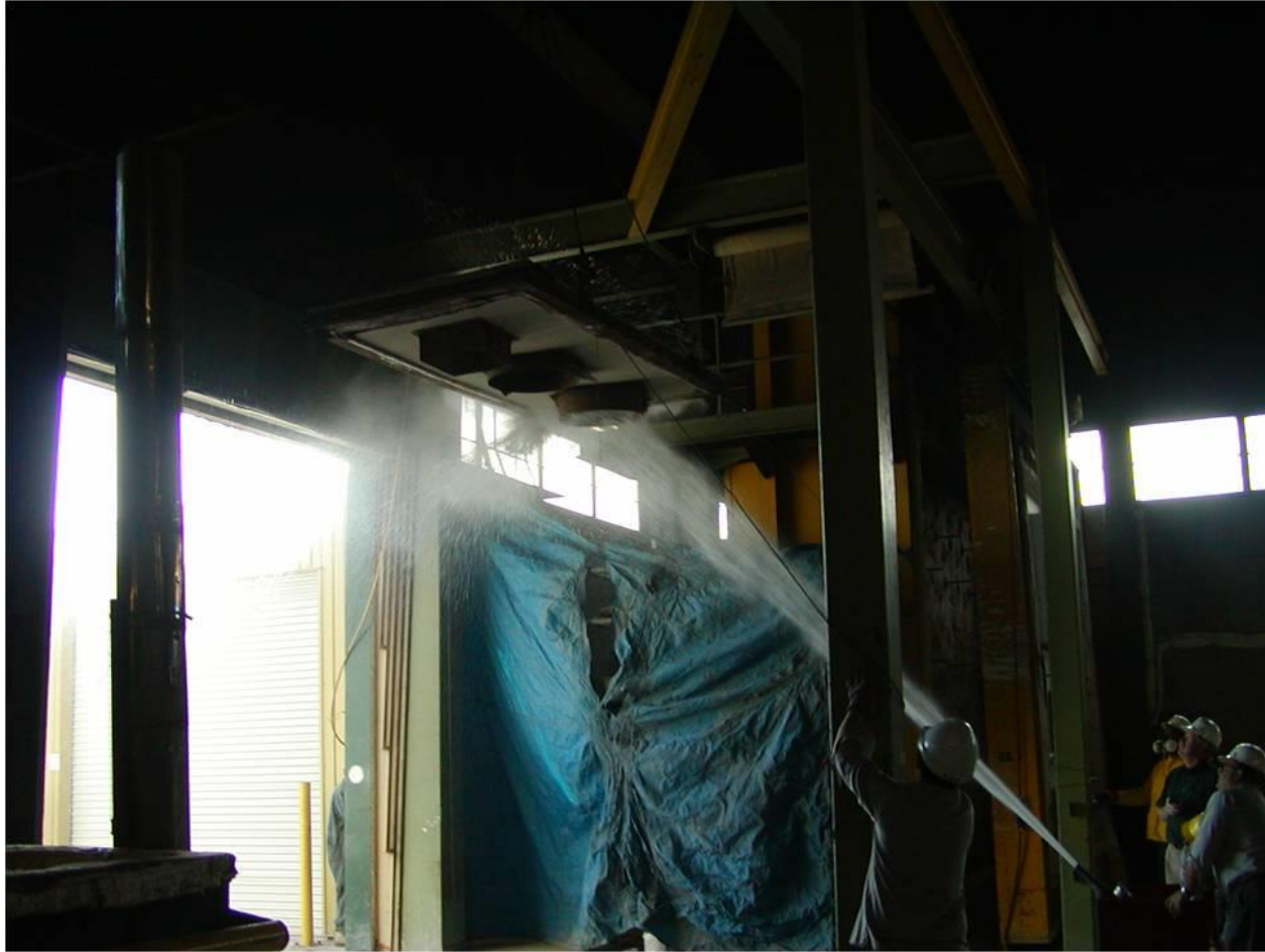
Flux de tuyau après le test
